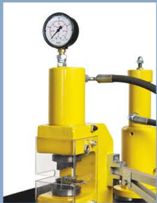
Banco di montaggio Hydraulic desk to assembly wire
